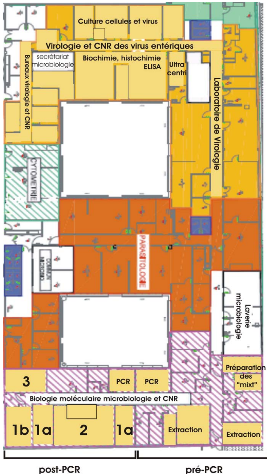
Figure 1 : Plan du laboratoire de virologie et place des activités liées au CNR « virus entériques ». Dans la zone biologie moléculaire microbiologie, le CNR dispose de pièces communes avec les autres activités de virologie, il s'agit des pièces de préparation des « mixt », d'extraction et celles des thermocycleurs. En post PCR, les pièces 1a sont dédiées au CNR et les pièces 2 et 3 sont partagées avec les autres activités de virologie.
